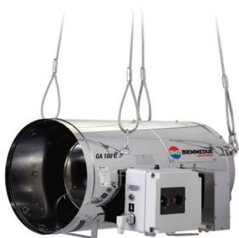
**GA:** корпус из нержавеющей стали для защиты от коррозии типичной для ангаров, работают на газе пропан-бутан, встроенная горелка, прямой нагрев, высокого давления (1.5 бар). Оснащены функцией автоматического старта благодаря прямому соединению блока управления с терmostатом контроля старта и остановки. Это самые экономичные нагреватели для применения в теплицах и ангарах.
