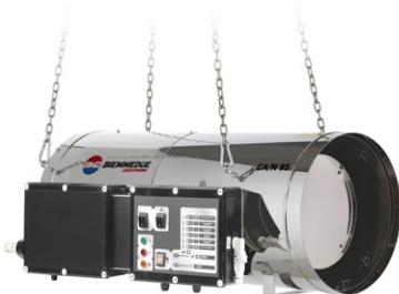
**GA/N:** корпус из нержавеющей стали, прямого нагрева, низкого давления, работают на газе пропан-бутан или метане (20-30 мбар), со встроенной горелкой. Возможна работа через пульт управления. В отличии от серии GA, нагреватели работают при низком давлении и могут быть установлены в помещении независимо от подаваемого напряжения
