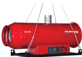
**EC/S и PHOEN/S:** корпус из окрашенной стали, дизельные, встроенная (EC) и выносная (PHOEN) горелки, не прямой нагрев. Нагреватели оснащены теплообменником, который отводит отработанные газы наружу через дымоход. Благодаря этому возможно их применение в закрытых помещениях. Однако, их стоимость более высокая, а КПД около 90 % из-за потери тепла через дымоход.
