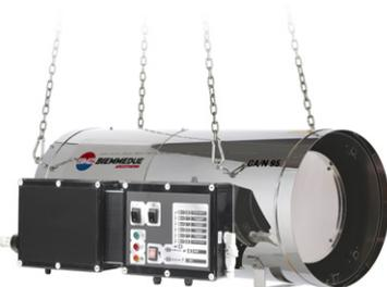
**GA/N:** корпус из нержавеющей стали, прямого нагрева, низкого давления, работают на газе пропан-бутан или метане (20-30 мбар), со встроенной горелкой. Возможна работа через пульт управления. В отличие от серии GA, нагреватели работают при низком давлении и могут быть установлены в помещении независимо от подаваемого напряжения
