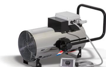
**EK P:** работают от электричества. Вместо горелки присутствуют электрические тэнсы, которые нагревают воздух подаваемый вентилятором. Эти характеристики делают возможным их применение в любых условиях, даже в закрытых помещениях. Однако, из-за ограниченной тепловой мощности, их применяют, если имеется возможность использовать дешевую электроэнергию и в небольших помещениях.
