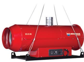
**EC/S и PHOEN/S:** корпус из окрашенной стали, дизельные, встроенная (EC) и выносная (PHOEN) горелки, непрямой нагрев. Нагреватели оснащены теплообменником, который отводит отработанные газы наружу через дымоход. Благодаря этому возможно их применение в закрытых помещениях. Однако, их стоимость более высокая, а КПД около 90 % из-за потери тепла через дымоход.
