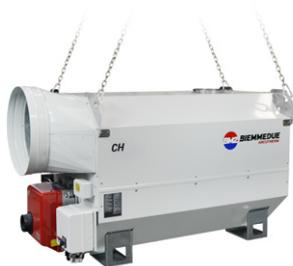
**CH:** из оцинкованной стали с покрытием, с косвенным сжиганием. Эти большие агрегаты для помещений с большим объемом могут быть оборудованы внешней горелкой, работающей на дизельном топливе, сжиженном нефтяном газе или метане. Они оснащены осевым вентилятором, который обеспечивает большее статическое давление. Рекомендуется для установки в воздуховодах или в очень длинных зданиях.
