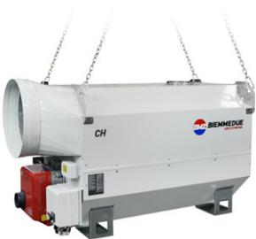
**CH:** из оцинкованной стали с покрытием, с косвенным сжиганием. Эти большие агрегаты для помещений с большим объемом могут быть оборудованы внешней горелкой, работающей на дизельном топливе, сжиженном нефтяном газе или метане. Они оснащены осевым вентилятором, который обеспечивает большее статическое давление. Рекомендуется для установки в воздуховодах или в очень длинных зданиях.
